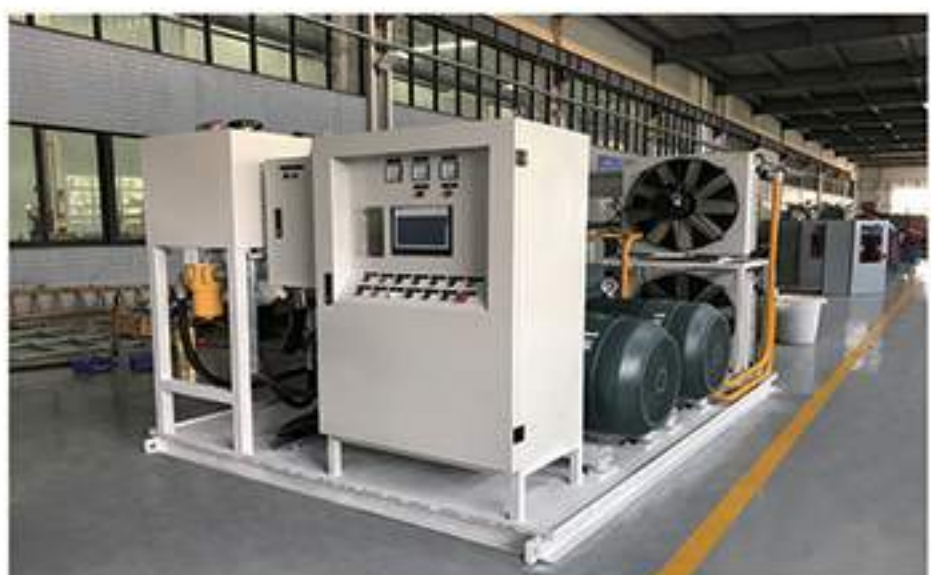
冶金行业——废钢破碎机液压系统
