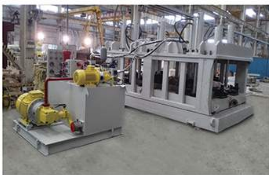
建材行业——人造石英石压机液压系统
