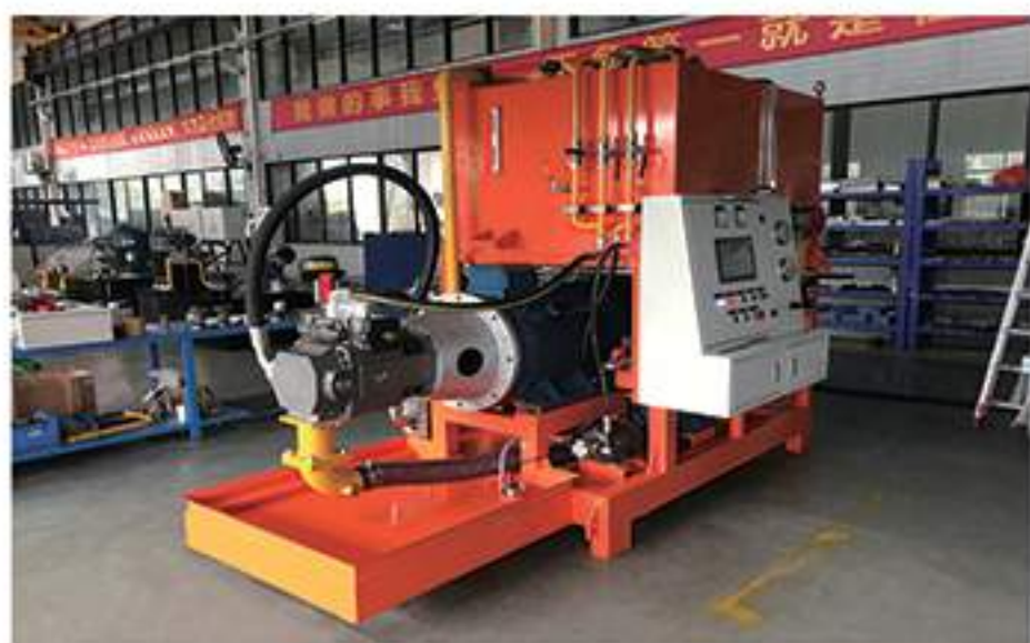
测试行业——液压测试系统
