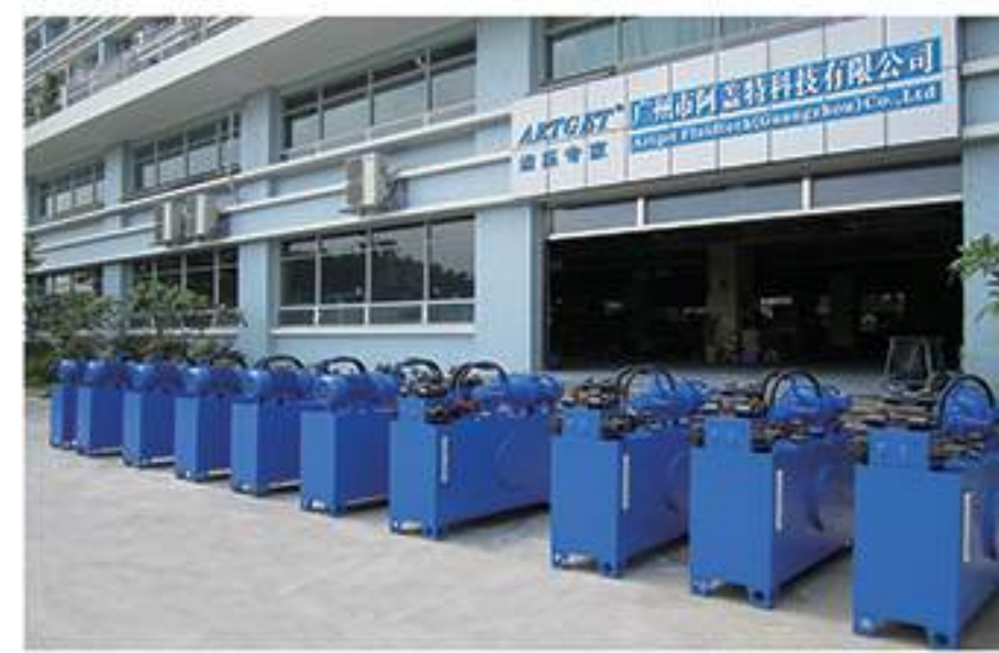
橡胶行业——泡沫成型机液压系统
