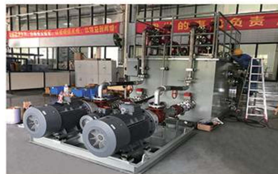
能源电力行业——供油装置液压系统
