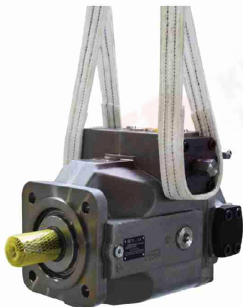
1. 扁平带吊两侧变量端盖
