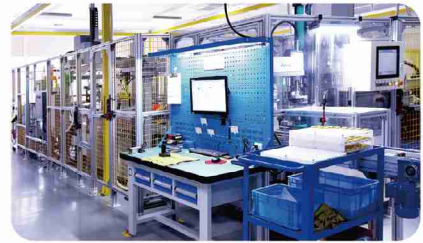
柱塞滑靴自动生产连线
