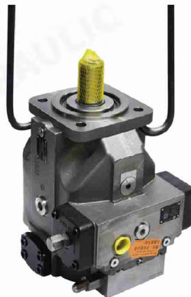
2. 双钩吊法兰对角孔
